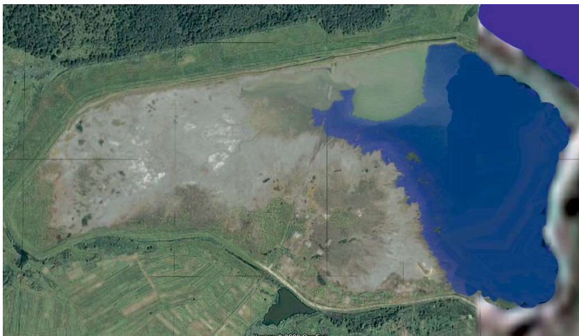
Рис. 18. Вигляд секції № 1 хвостосховища Стебницького ДГХП “Полімінерал” з космосу після прориву дамби, 1983 р.
