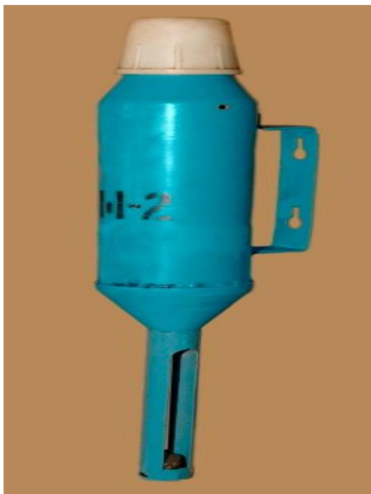
Рис. 6. Прилад для вимірювання піску.
