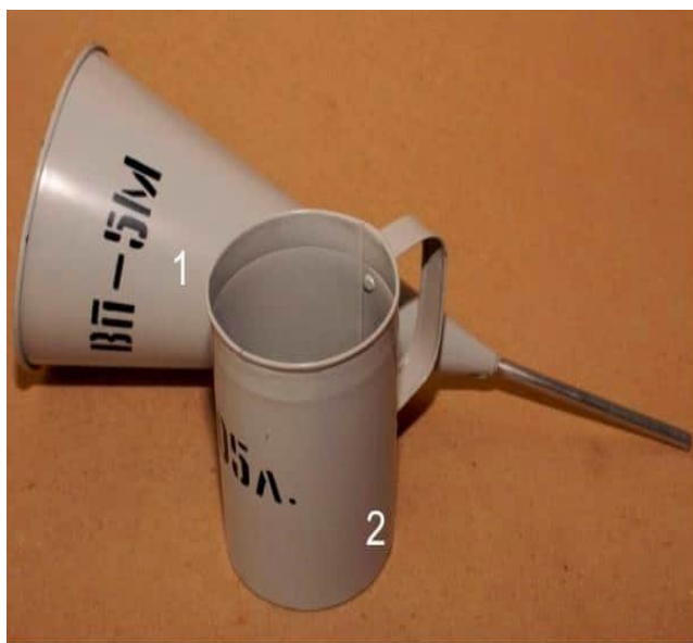
Рис.2. Польовий віскозиметр ВП-5: віскозиметр (1) та мірний кухоль (2).
