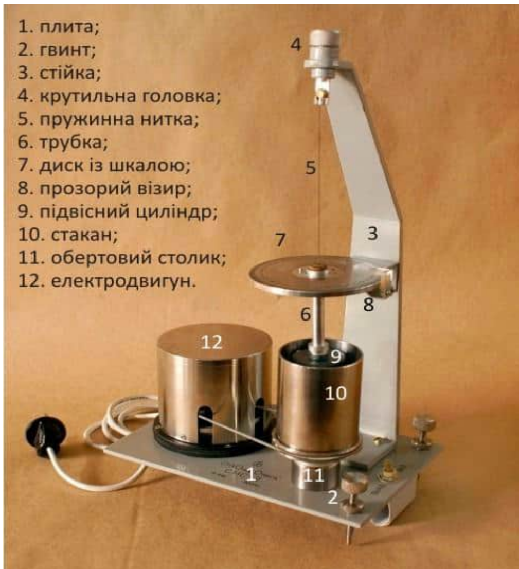
Рис. 3. Прилад СНС-2 для виміру статичної напруги зсуву
