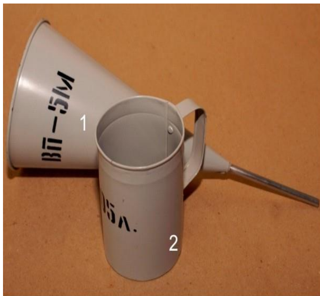
Рис.2. Польовий віскозиметр ВП-5: віскозиметр (1) та мірний кухоль (2).
