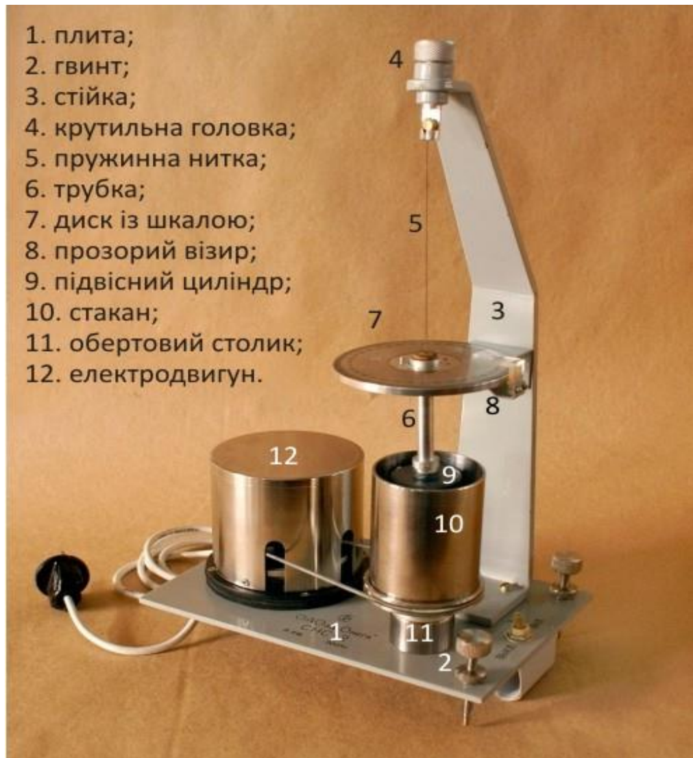
Рис. 3. Прилад СНС-2 для виміру статичної напруги зсуву
