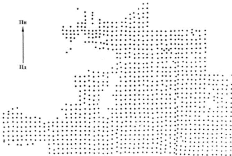
Рис. 12. Система площинного розшукового буріння та опробування на перспективній території ділянки Килахської (Якутія). Відстань між окремими свердловинами 250 м.
