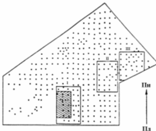
Рис. 13. Система площинного розшукового опробування на перспективній території ділянки Верхньо-Ситиканської (Західна Якутія): I-III – площі, рекомендовані для довивчення (заштриховано ділянки, які рекомендовано вивчати першими).
