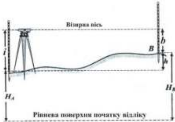
Рис. 50. Геометричне нівелювання способом уперед
