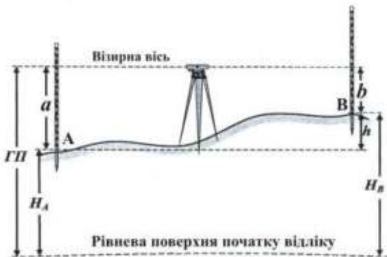
Рис. 49. Геометричне нівелювання способом від середини
