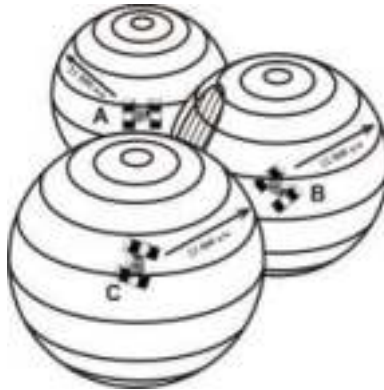
Рис. 57. Визначення положення точки за радіосигналами від трьох супутників
